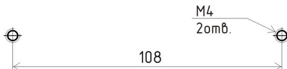
Рисунок 4 - Шаблон для сверления отверстий крепления
